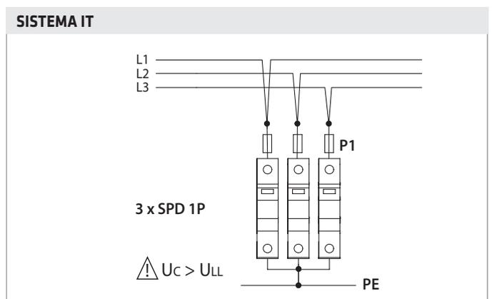
P1 = fusibile o interruttore magnetotermico
