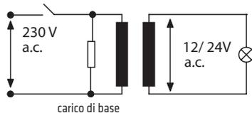
Il biointerruttore funziona correttamente aggiungendo in parallelo al trasformatore, a valle dell'interruttore di comando, il carico di base. L'interruttore di comando lampade deve essere posizionato a monte del trasformatore (lato 230V a.c.).
